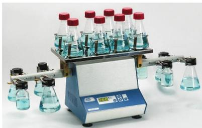
Modelo Vibromatic con plataforma adaptada.
