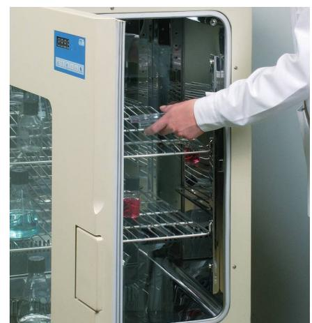
La óptima homogeneización de la temperatura se consigue con una razonable distribución del espacio y carga, no sobrepasando el 70% del volumen útil.
