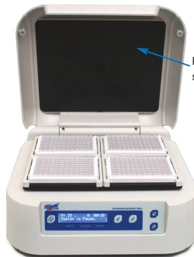
Placa interior con sistema de calentamiento simultáneo a la plataforma principal.
