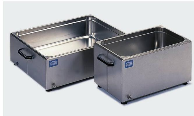
Cubetas metálicas especiales, aisladas térmicamente. Para soportar bajas temperaturas. Útiles para nuestras unidades refrigeradoras. De iguales características que las anteriores y aisladas con espuma inyectada de poliuretano expandido, para evitar fugas térmicas y condensaciones entre -40 °C y +90 °C.
