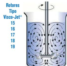
**Flujo Radial Dinámico**, incidencia gráfica del principio cónico en el medio de agitación. Agrupa toda la serie de rotores Visco-Jet®. Excelentes resultados y de mínimo consumo.
