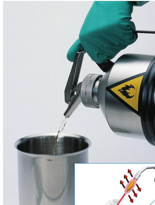
Dispensador de precisión con autocierre que facilita una dosificación exacta.
