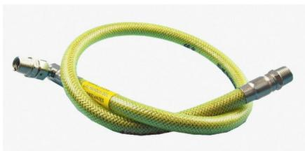
Conjunto espirometálico de 100 cm de largo con conexión al mechero de 1/2" y extremo con dispositivo de conexión rápida y válvula de seguridad. Según normas UNE 60715 y BS 669.
